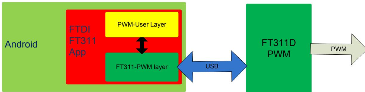
Figure 4.1 : Android FTDI FT311D PWM Application
